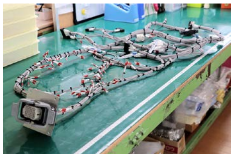
海外の列車で空調に用いられるハーネス。配線は何本にも分岐している。
