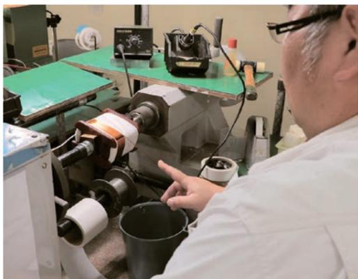
トランス生産の様子。この製品は導線が太く扱いが難しい。指で圧力を加えることで、導線が整然と巻かれていく。
