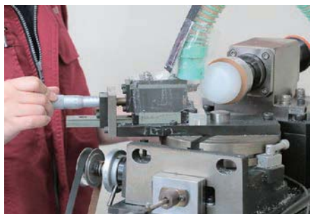
当時、自社製作した切削加工装置。改良を重ね、微調整が必要なときは今でも使用している。
