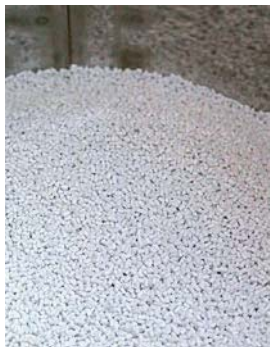
成形前のペレット。平均1mm×2mmほどで、最大320度で熱する。
